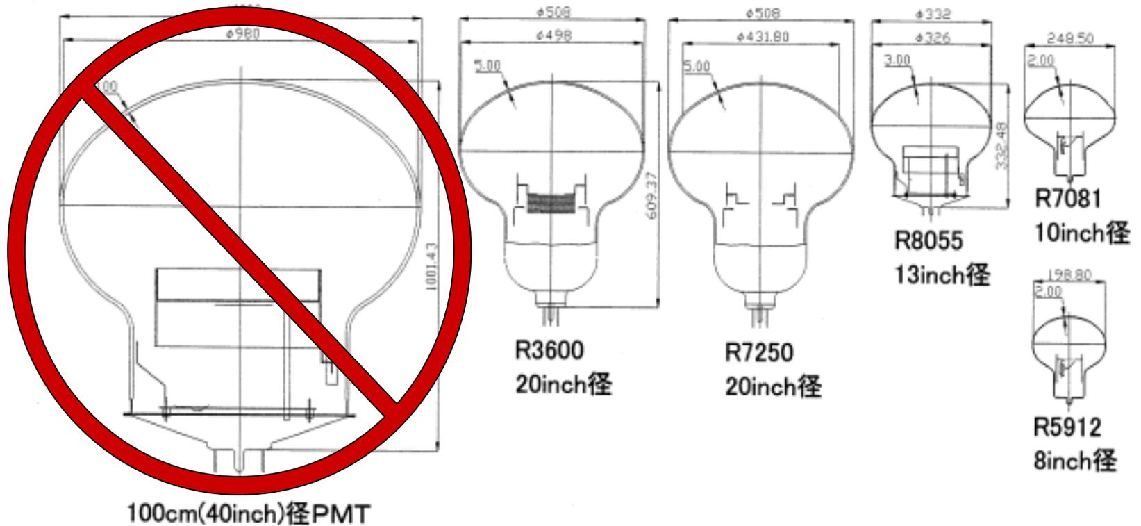
大口径PMT R3600 vs 超大径PMT
